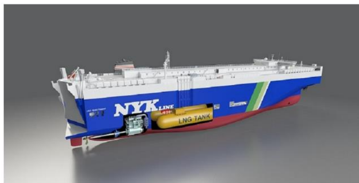
図-3 プロジェクト-02 LNG 燃料自動車専用船(イメージ)
