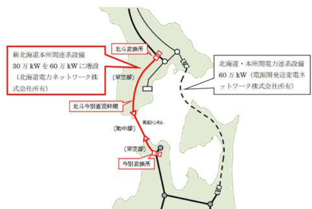
新北海道本州間連系設備(新々北本連系設備)
