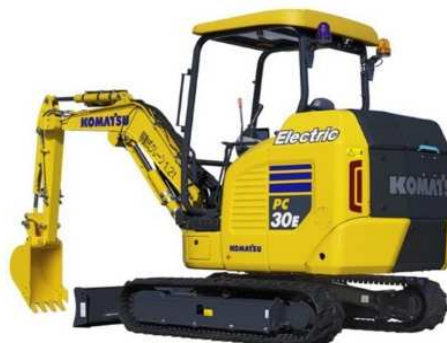
Picture-2 Project A-1) Electric Mini excavator PC30E-5(example)
