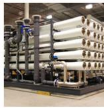
NF/RO膜ろ過装置
