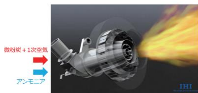
図-1 アンモニア石炭混焼バーナ概略図
