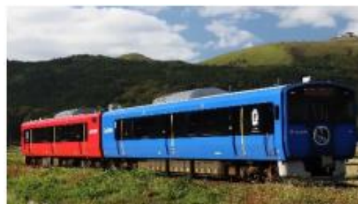
図-2 交流蓄電池電車 EV-E801 系車両外観
